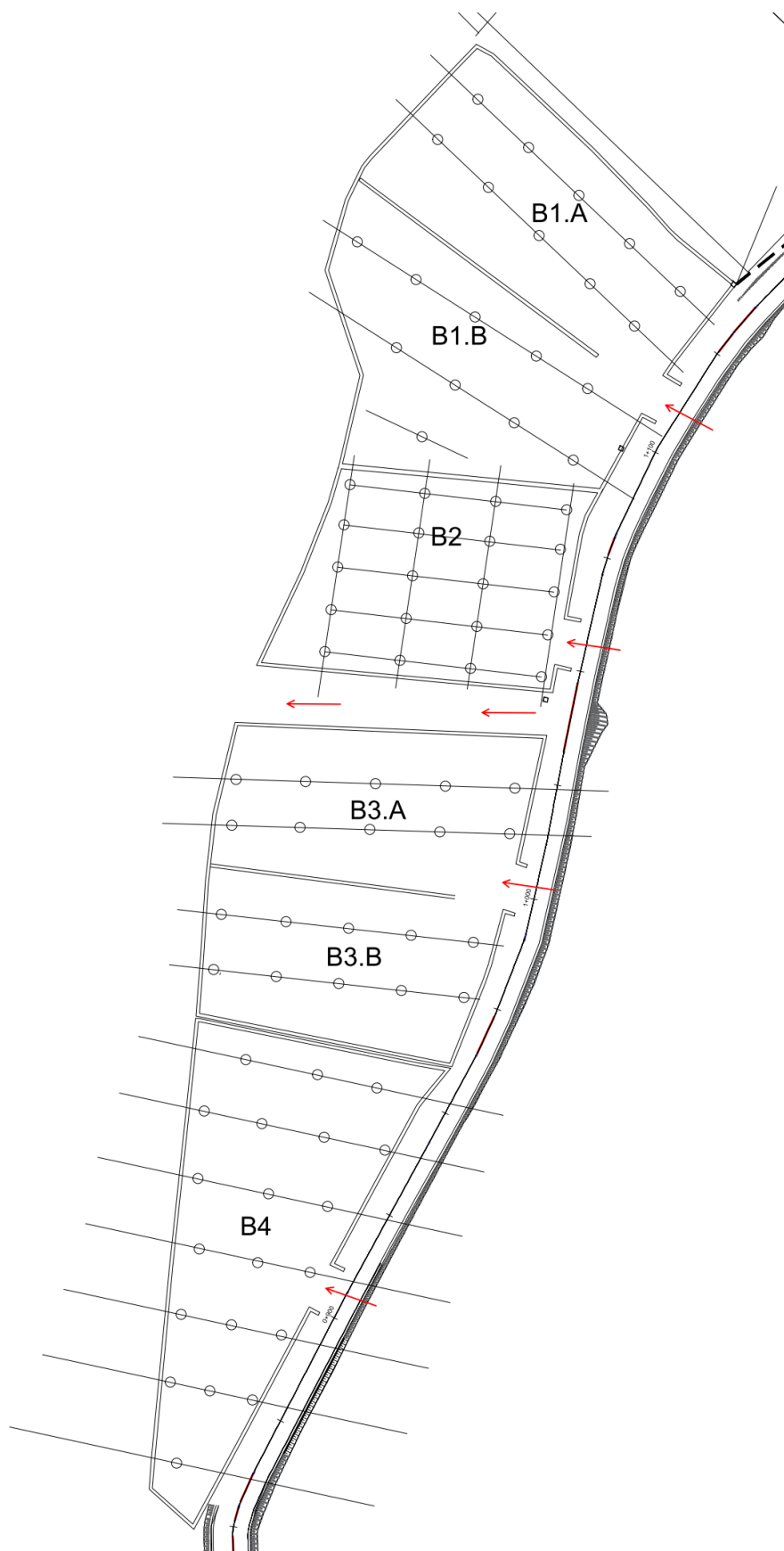
Figura 2 - stralcio della planimetria allegata alla nota del Consorzio, riportante la geometria effettiva delle piazzole e le ubicazioni delle verticali di campionamento aggiornate (10 per ciascuna piazzola, con due incrementi per verticale, eccetto B2 e B4 con 20 verticali ad unico incremento per verticale).
